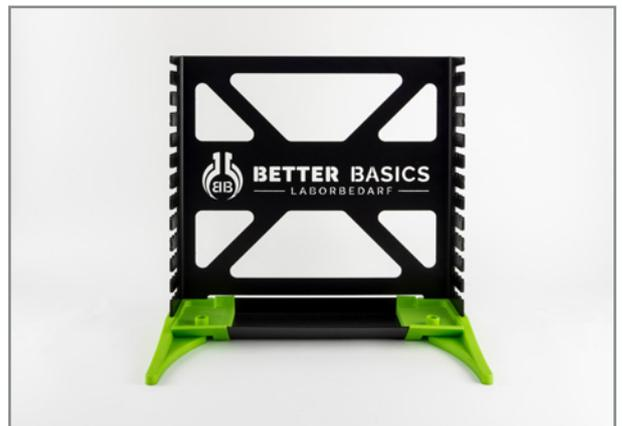
4. **Hängen Sie die Nutschienen in benötigter Anzahl (meist drei bis vier Nutschienen) in das SmartRack®** indem Sie diese an den Griffen an der linken und rechten Seite der Nutschiene halten und sie in die gewünschte Position bringen. Es gibt in jeder Höhe drei Positionsmöglichkeiten. Bitte ändern Sie die Position der Nutschienen immer ohne eingehängte Halterungsmodule.
